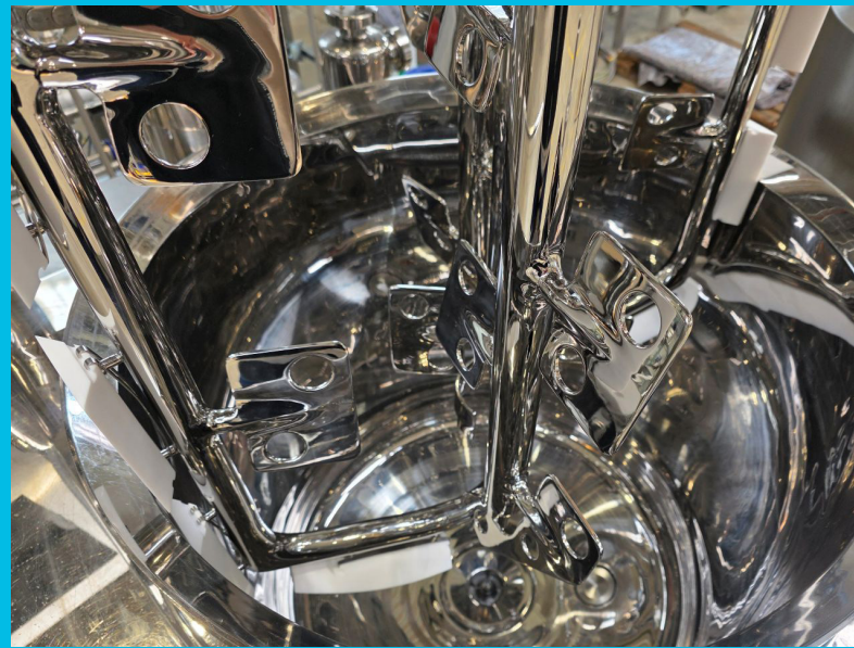
Ansatzbehälter innen mit Turborührer
