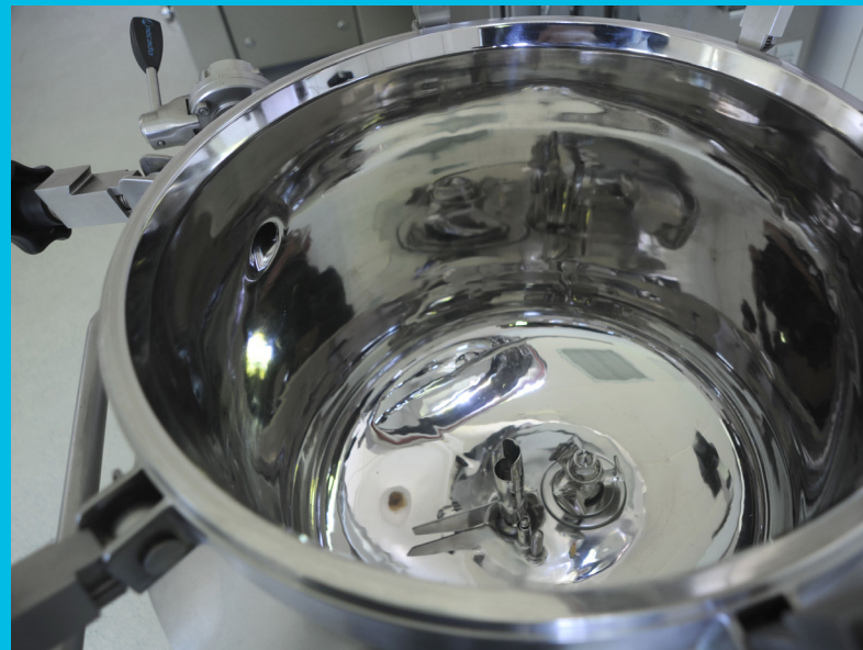
Ansatzbehälter innen mit Turborührer
